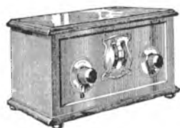
De BRANDESET III a. Een moderne 3-lamps ontvanger (detector en 2 laagfr.) van opvallend ontwerp.
